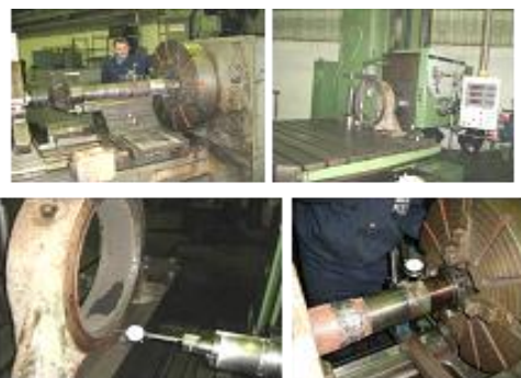
Figura 11. Mënyrat e shtrëngimit, përqendrimi dhe nivelimi i detaleve në makinat për përpunim me prerje duke përdorur indikatorin e detaleve
