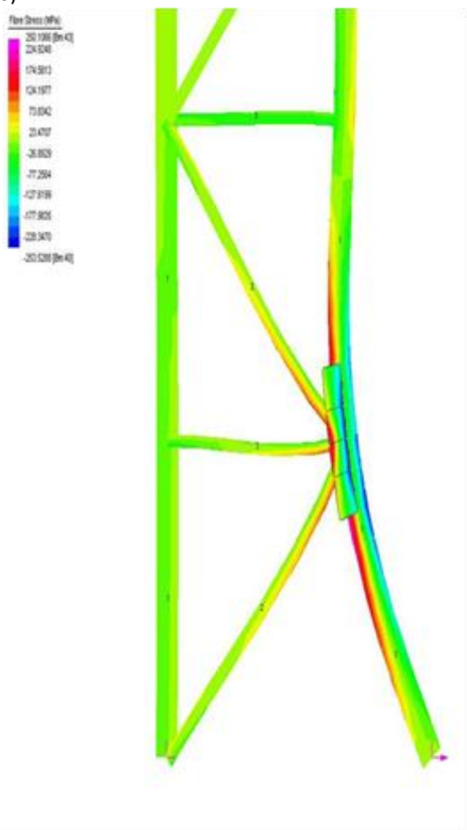
Figura 2. Tensionet në pjesën e poshtme të kolonës.
