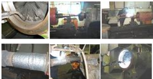
Figura 8. Zgjedhja e distancës së kokës salduese, shpejtësisë, hapit dhe numrit të shtresave
