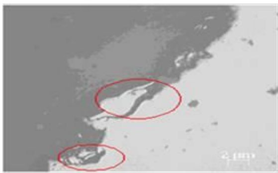
Figura 9a. Shtresa e korroduar
