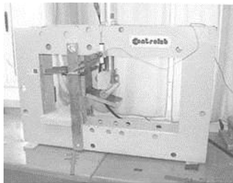
Figura 1 Provat për përcaktimin e rezistencës së aksesorëve montues të mobilieve
