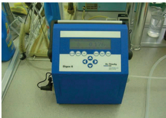
Figura 2. Aparati Digox 6 për përcaktimin e oksigjenit në birrë
