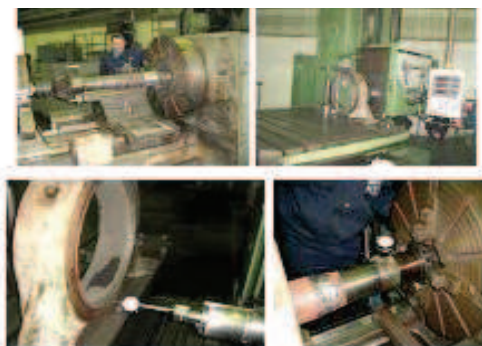
Figura 11. Mënyrat e shtrëngimit, përqendrimi dhe nivelimi i detaleve në makinat për përpunim me prerje duke përdorur indikatorin e detaleve
